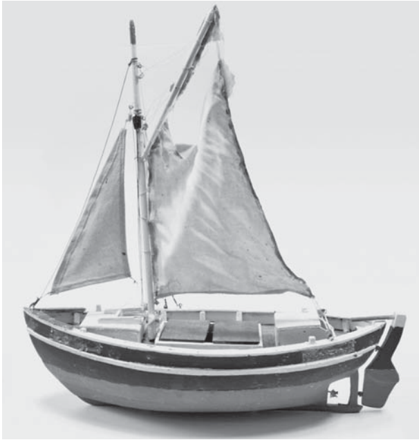
ECKE 34 im Jahre 1920 als frisch gebaute Quase. Man beachte das für Quasen ungewöhnlich simple Rigg ohne Baum, Toppsiegel und Bugspriet und nur einem Vorsegel als Selbstwendefock. Kennzeichen der Übergangszeit zum Motor-Zeitalter.
