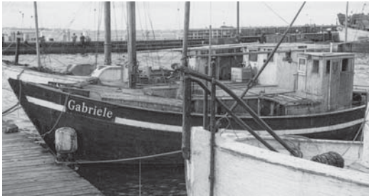
VIVIKA als Fischkutter GABRIELE Anfang der 60er Jahre. Man beachte die starke Vorstevenneigung im Vergleich zu den anderen Kuttern – sie verrät ihre Vergangenheit als Segler.
